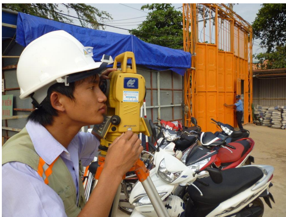
Hình 5.4: Máy toàn đạc điện tử Topcon GTS-235N và thao tác đo
